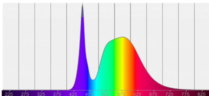
Das STAR LED Flutlicht ist ein leistungsstarkes Beleuchtungssystem mit 60W Leistung und einer Farbtemperatur von 5000K, das eine Helligkeit von 9000lm erzeugt. Mit einem asymmetrischen
